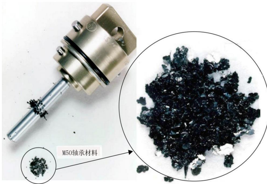
图 20-3 磁堵及吸附到的轴承颗粒
